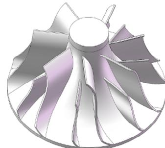
图5 带分流叶片的叶轮模型
