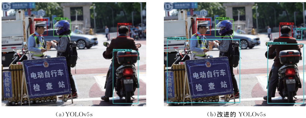
图 7 存在小目标和遮挡目标时的检测结果
