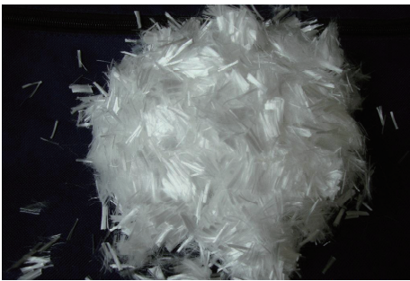
图 3 实验用的聚丙烯纤维
