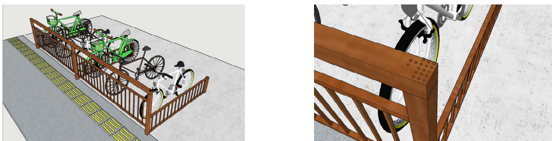
图7 在非机动车位、栅栏、扶手设置盲文用于提示视障者
