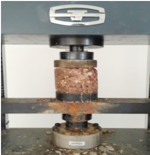
图 3 试件受压破坏图
