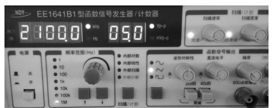
图 4 函数信号发生器输出的 2.1 MHz 被测脉冲信号
